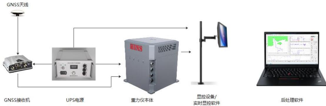
**重力仪本体** (SU, Sensor Unit) 是重力仪的核心部件，功能是由于测量载体的惯性加速度，重力仪本体由重力传感器、姿态传感器、温控系统、电气系统等组成，重力传感器采用国产高精度石英挠性加速度计，姿态传感器采用国产高精度光纤陀螺。
