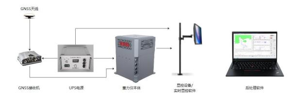
重力仪本体(SU, Sensor Unit)是航空重力仪的核心部件,功能是用于测量载体的惯性加速度,重力仪本体由重力传感器、姿态传感器、温控系统、电气系统等组成,重力传感器采用国产高精度石英挠性加速度计,姿态传感器采用国产高精度激光陀螺。
